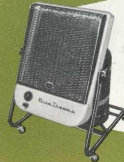
Les appareils types 307 P et 307 EP peuvent être utilisés indifféremment avec le **butane** (détendeur de 28 ou 30 g/cm<sup>2</sup>) ou le **propane** (détendeur de 37 g/cm<sup>2</sup>).
